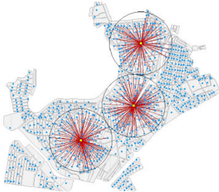
Figura 2: Solução de máxima cobertura para 3 antenas
